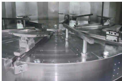
Geschmiedeter Rohling rein – fertig raus: Mit dem 6-Backen-Aushebefutter von Röhм können die Werkstücke in nur einer Aufspannung komplett auf der VTM bearbeitet werden.
