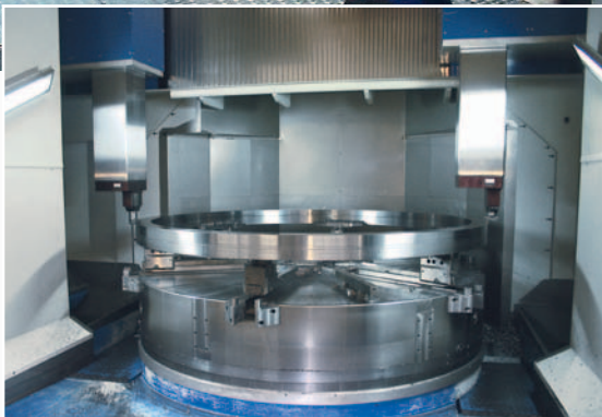
VTM 302: Die Bearbeitung erfolgt mit zwei Arbeitseinheiten.
