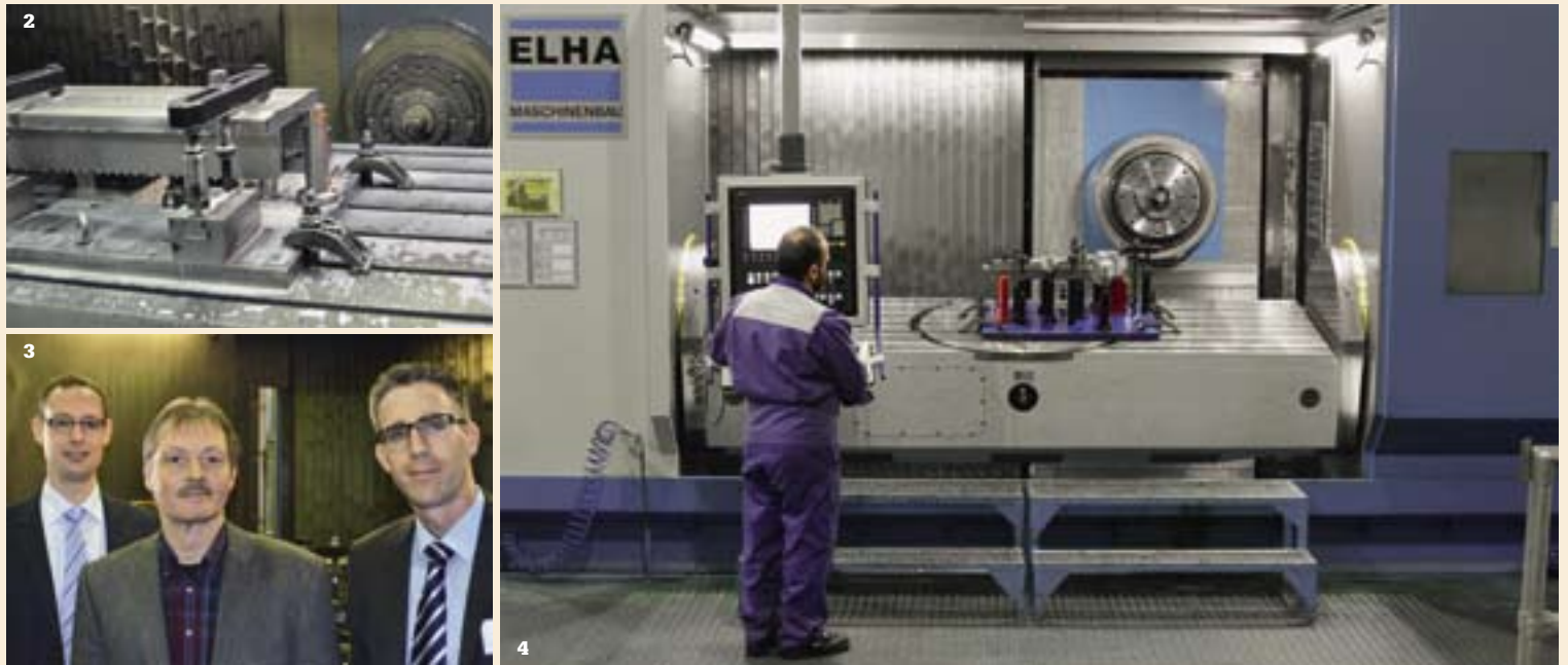
2 Auf der Maschine werden hauptsächlich hochbelastete Struktur-Titanteile bearbeitet. 3 (v. l. n. r.): Michael Wieschmann (Elha-Maschinenbau), Dirk Spielmann (Otto Fuchs) und Stefan Bertram (Friedel Bertram GmbH). 4 Mit einem Drehmoment von bis zu 2058 Nm im S6-Betrieb hat die SMX 5224 große Leistungsreserven.
