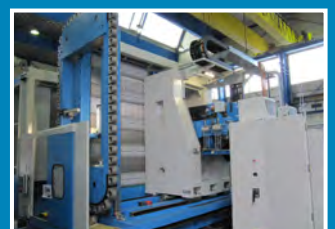
SMX 5224 Platzsparend integriertes 60-fach Magazin
