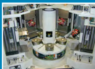
SPX 4979 5-Stationen-Planetentisch- maschine
