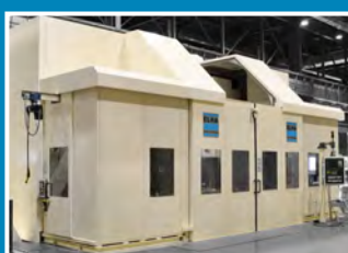
VTM 402 ht Maschine für Hartdreh- bearbeitung
