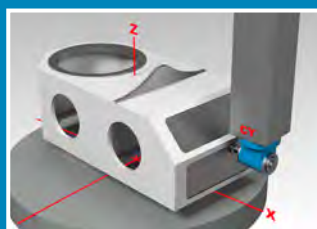
Seitenbearbeitung: 4-Achsen-Interpolation mit Horizontalkopf
