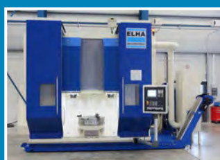
RTX 5280 Zweispindlige vertikale Bearbeitung von Lochscheiben
