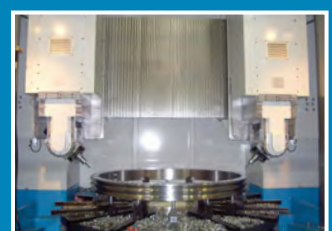
RTX 5135 Zweispindlige Bearbeitung mit H/V-Bohr- und Fräsköpfen
