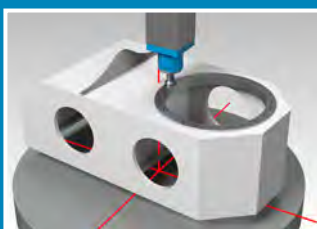
Vertikalebearbeitung: 3-Achsen-Interpolation mit Vertikalkopf
