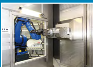
SMX 5181 Automatischer Werkzeugwechsel durch Roboter
