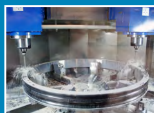
RTX 5211 Zweispindlige vertikale Bearbeitung von Lagerringen
