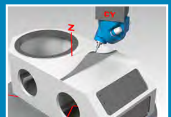
Freiformflächenbearbeitung: 5-Achsen-Interpolation mit H/V- Schwenkkopf
