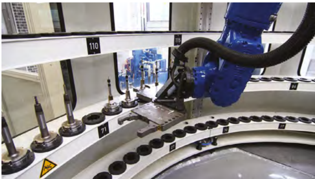
Tool Arena mit Werkzeugwechselroboter
