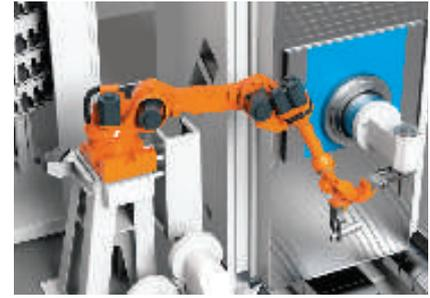
Beim Werkzeugwechsel reicht die Positioniergenauigkeit des Roboters aus, um Werkzeuge mit bis zu 50 kg, als Einzelwerkzeug, in die HSK-A-100 einzufuttern.
