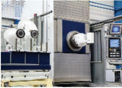
Die Vorsatzaggregate können automatisch über ein Pick-Up-Wechselsystem getauscht werden. Dabei werden sie über eine elektromechanische Verschiebeeinheit vor der Pinole positioniert.
