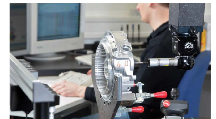
Vermessung mit 3D-Messmaschine
