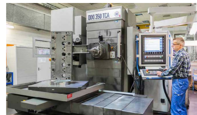
Lehrenbohrwerk im klimatisierten Raum
