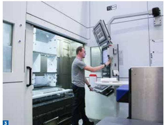
rollierte Abwärtsbewegung des Pressbalkens gebogen. Hierbei wird das flache Blech von einem Oberwerkzeug in ein V-förmiges Unterwerkzeug (Matrize) gedrückt und dabei geradlinig umgeformt. Die Hinteranschlüge sorgen für eine exakte Position des Werkstücks“, erklärt DI (FH) Bernhard Zipko, Leitung Produktion bei Trumpf.
