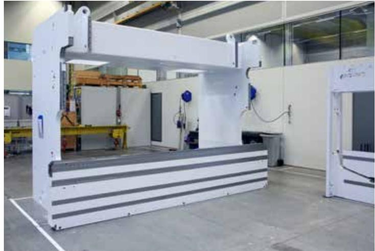
Varianten in diesen beiden Bearbeitungszentren – just-in-time. Das bedeutet, dass die Zykluszeiten niedrig, aber die Genauigkeiten sehr hoch sein müssen. Wir dulden selbst bei viereinhalb Meter langen Rahmen lediglich zwei hundertstel Millimeter Toleranz.“
