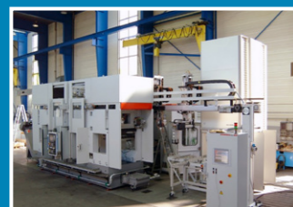
SMX 6100 Doppel-Vario-Modul mit Werkzeugspeicher
