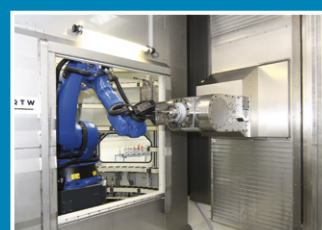
SMX 5181 Automatischer Werkzeugwechsel durch Roboter
