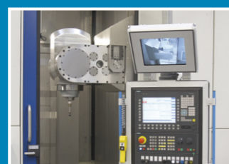
SMX 5181 Frei schwenkbares Kamerasystem für Überwachung
