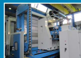
SMX 5224 Platzsparend integriertes 60-fach Magazin
