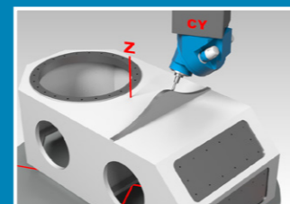
Freiformflächenbearbeitung: 5-Achsen-Interpolation mit H/V-Schwenkkopf
