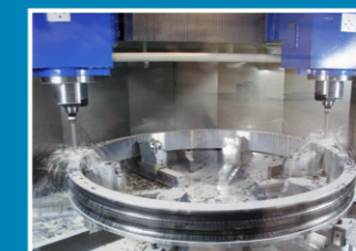
RTX 5211 Zweispindlige vertikale Bearbeitung von Lagerringen
