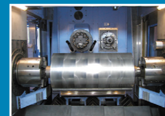
SPX 5111 Arbeitsraum mit eingespanntem Druckzylinder
