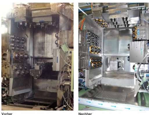
Abb. 3: Überholung ELHA Fertigungsmodul
