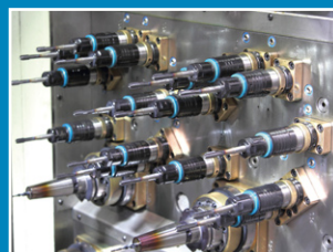
Beispiele Mehrspindelköpfe (MSK) in ELHA FM Fertigungsmodulen. Anzahl, Größe, Abstände und Anordnung der Spindeln werden prozessspezifisch festgelegt.
