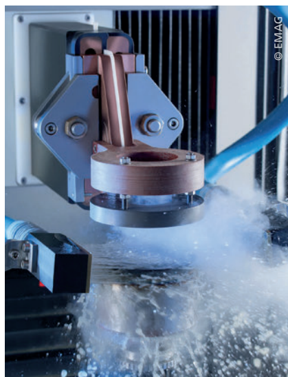
EMAG-Maschine eQC Quench überwacht das Abschreckmittel während des Härteprozesses
