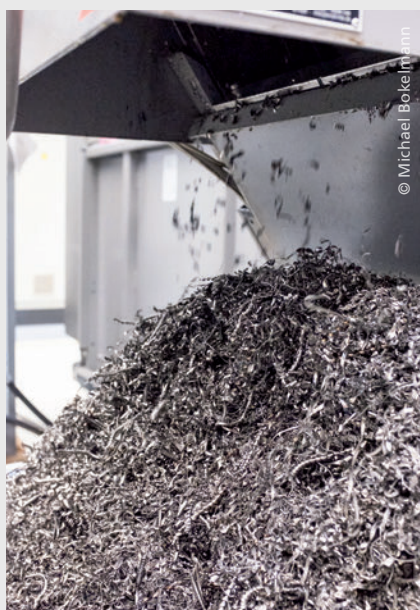
Werkzeugmaschinen machen aus groben Metallstücken präzise verarbeitete Werkstücke, wobei riesige Mengen Metallspäne anfallen
